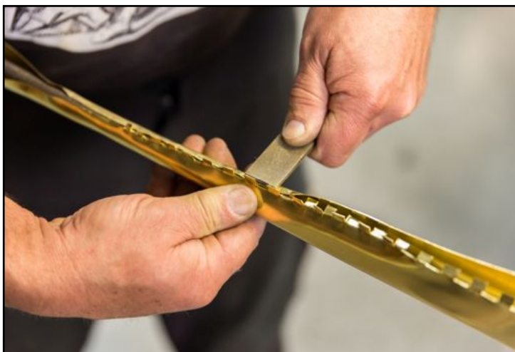
Abb 6. Ein „Zahn“ unten, ein „Zahn“ oben wird das Blech wie ein Reißverschluss zusammengefügt. Die Flachfeile ist ein gutes Hilfsmittel Fig 6. The teeth are engaged with each other, alternating over and under. The end of a file is useful for pushing the teeth together
