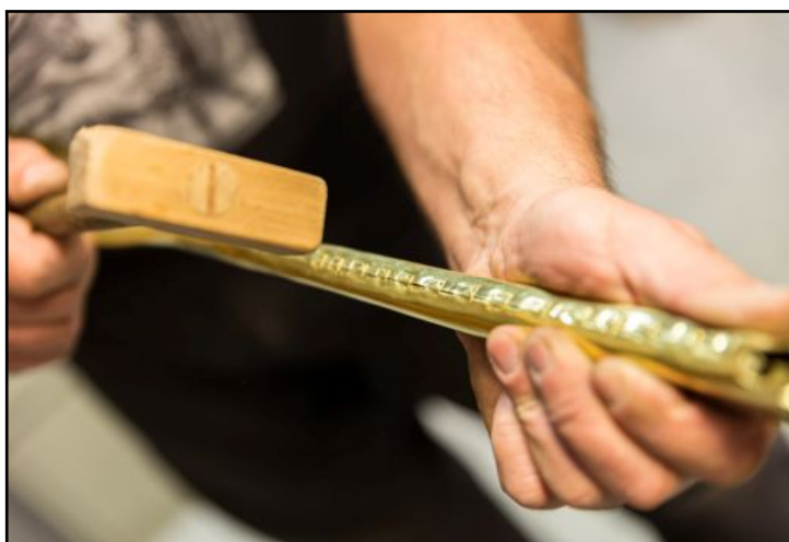
Abb 7. Mit dem Holzhammer die Lotnaht auf der Stange glätten und endgültig fest zusammenfügen Fig 7. The teeth are tapped tightly together using a wooden mallet, with the bell laid on a steel mandrel
