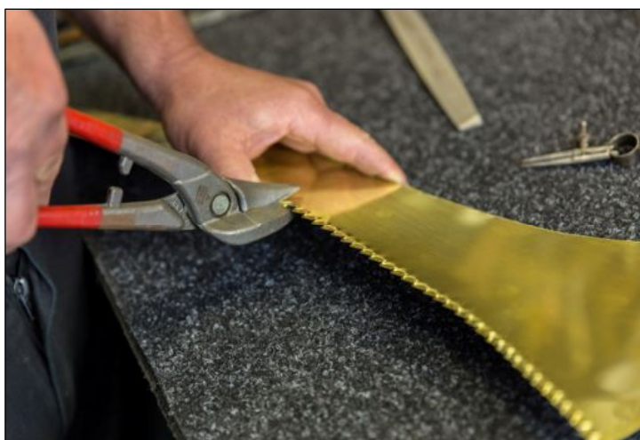
Abb 3. Mit dem Zirkel eine Abstandslinie ca. 4mm vom Rand markieren und „Zähne“ bis zu dieser Markierung einschneiden. Die Lotnaht ist später sichtbar, daher sind gleichmäßige „Zähne“ wichtig
